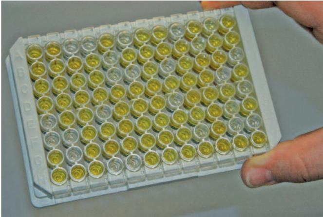
PAG-positive Proben erscheinen im Ergebnis in einem Gelbton. PAG-negative Proben bleiben farblos. 90 Trächtigkeitstests können mit einer Platte untersucht werden.
