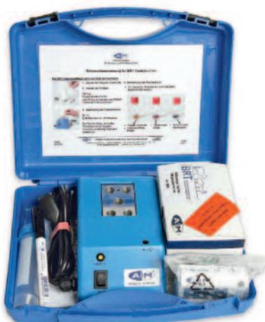
Das Hoftest Einsteiger-Set gibt es in zwei Varianten. Der hochsensitive Test sollte nur für die Sammelmilch verwendet werden, der normale BRT-Test wird für Einzelkühe verwendet. Foto: AIM
