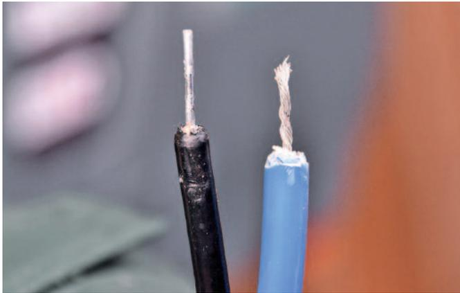
Wer sich langfristig Ärger ersparen will, verlegt als Stromleitung doppelt-isolierten Alu-Zink-Stahldraht (L.) in den Boden, sowohl als Zuleitung zum Zaun, wie auch zu den Erdungsstäben. Fein gedrahter Kupferdraht ist selbst dann nicht geeignet, wenn er verzinkt ist.
