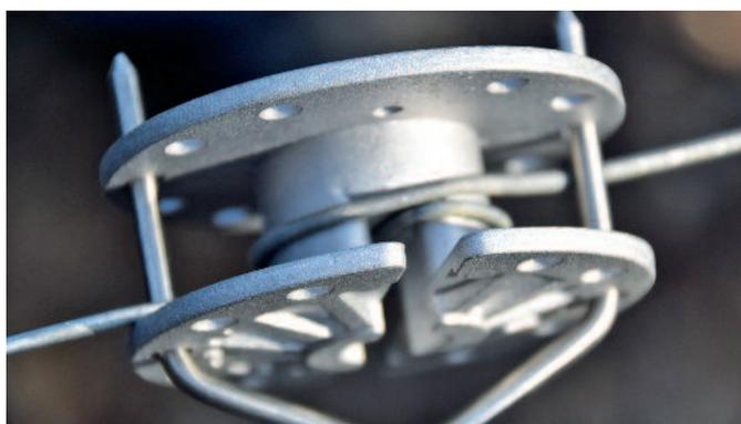
Mit dem Zaunspanner kann der Draht problemlos auf die erforderliche Zugkraft von 100 kg vorgespannt werden. Beim Einsatz der Ratsche aus der eigenen Werkstatt sollte aber möglichst ein zweiter Mann mithelfen.
