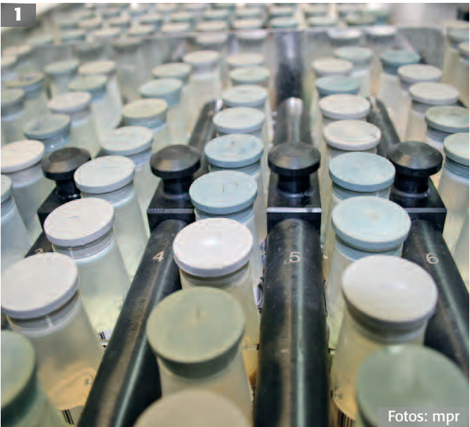
1. Am sogenannten Zuführtisch werden die Proben optimal auf die Untersuchung vorbereitet. Dabei durchlaufen sie eine spezielle Anwärmestation.
