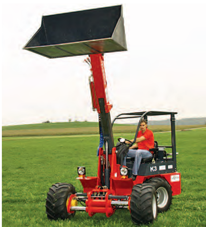
Dieser Knicklader durchfährt dank der hydraulisch teleskopierbaren Vorderachse schmalste Futtergänge und ist bei Bedarf binnen Sekunden breiter und damit extrem kippstabil. Werkfoto
