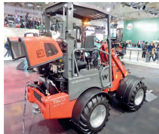
Mit Elektroantrieb ist der e-Hoftrac von Weidemann besonders für schlecht zu belüftende Ställe oder Hofgebäude geeignet. Für niedrige Durchfahrten kann das Fahrer-schutzdach hydraulisch abgesenkt werden.
