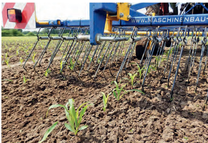
Treffler-Striegel mit indirekter Zinkenaufhängung.
