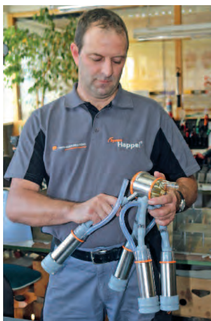
TM AktivPULS Melkzeug der neuesten Generation bei der Montage in Salenwang. Alle milchführenden Teile sind hier aus Silicon, für noch schonenderes Melken.
