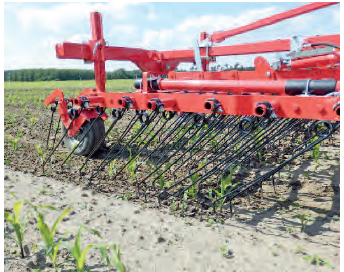
Einböck-Striegel mit direkter Zinkenaufhängung.
