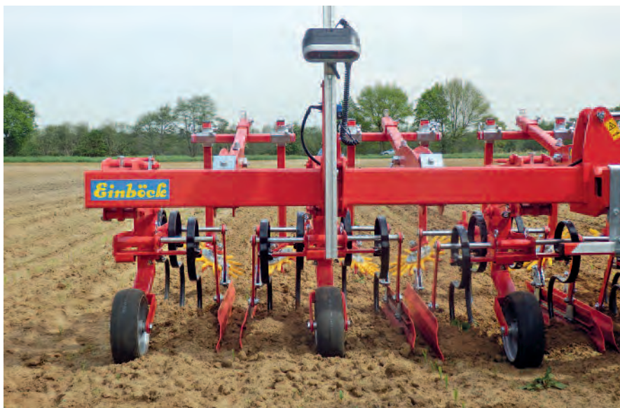
Die Kamerahacktechnik ist praxistauglich, verbessert die Flächenleistung und entlastet den Fahrer.
