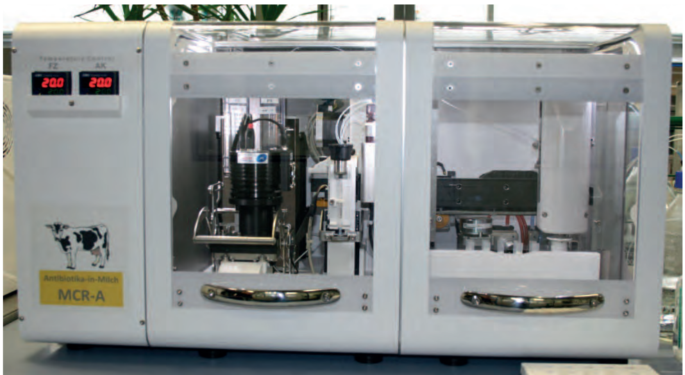
Mit dem neuen BioSensor MCR-A können in Minutenschnelle 13 verschiedene Antibiotika aus einer Milchprobe differenziert werden.
