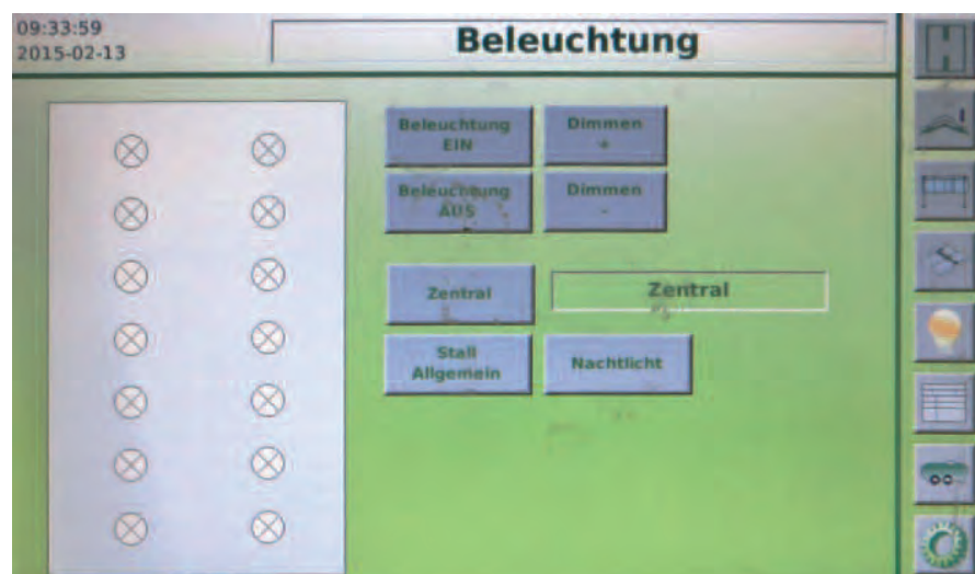
Steuereinheit für LED-Lampen im Stall; die Bedienung ist auch über Tablet-PCs oder Smartphones möglich.
