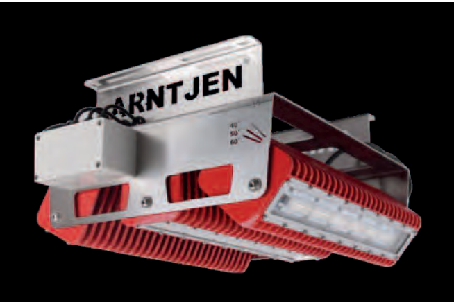
Diese Triplex-Lampen können mit einer Leuchtenreihe Ställe bis zu einer Breite von 35 m ausleuchten. Sie benötigen Installationshöhen von über 4 m. Es gibt sie auch als Duplex- und in Einzelausführung.
